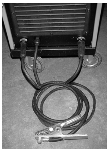
Collegamento per la saldatura in atmosfera controllata.
