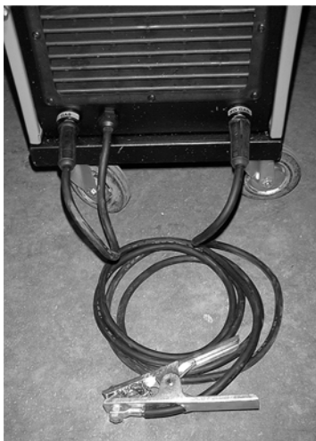
Priključak za režim u zaštitnoj atmosferi
