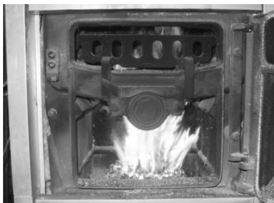
Obr. č. 27 Optimální tvar plamene
