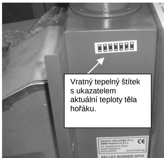
Obr. č. 7 Umístění tepelných štítků na hořáku
